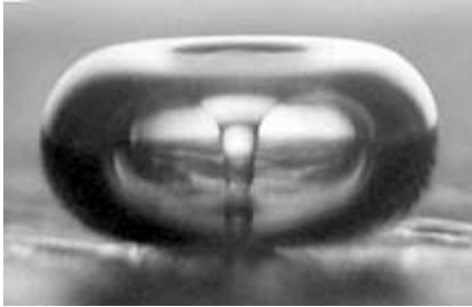
Cavities bel aan het oppervlak van een te reinigen voorwerp.
