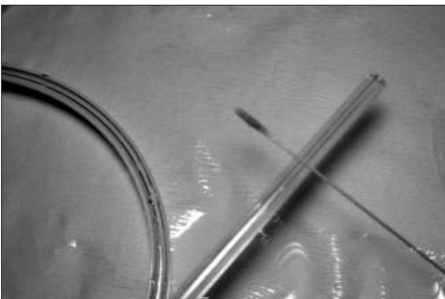
Image 3: Réaction négative au gaïac lors d'un test tampon de capillaires rincés et simultanément traités à l'ultrason.
