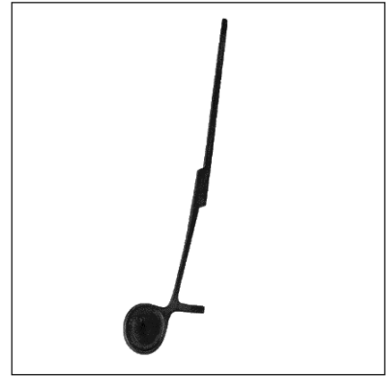
Abb. 3 Rohling, Aussengrat geschnitten
