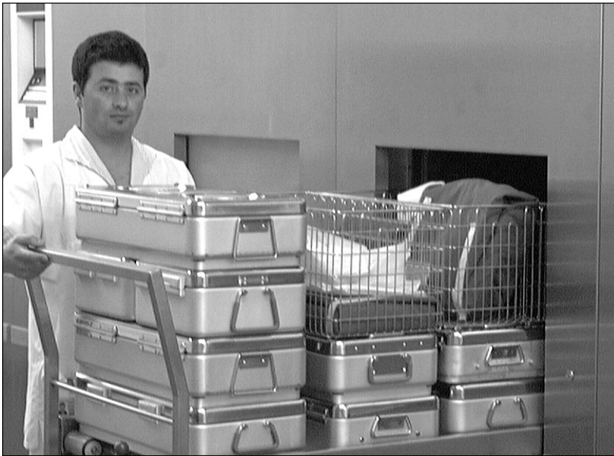
Abb. 3: Beladung der Dampf-Sterilisatoren.
