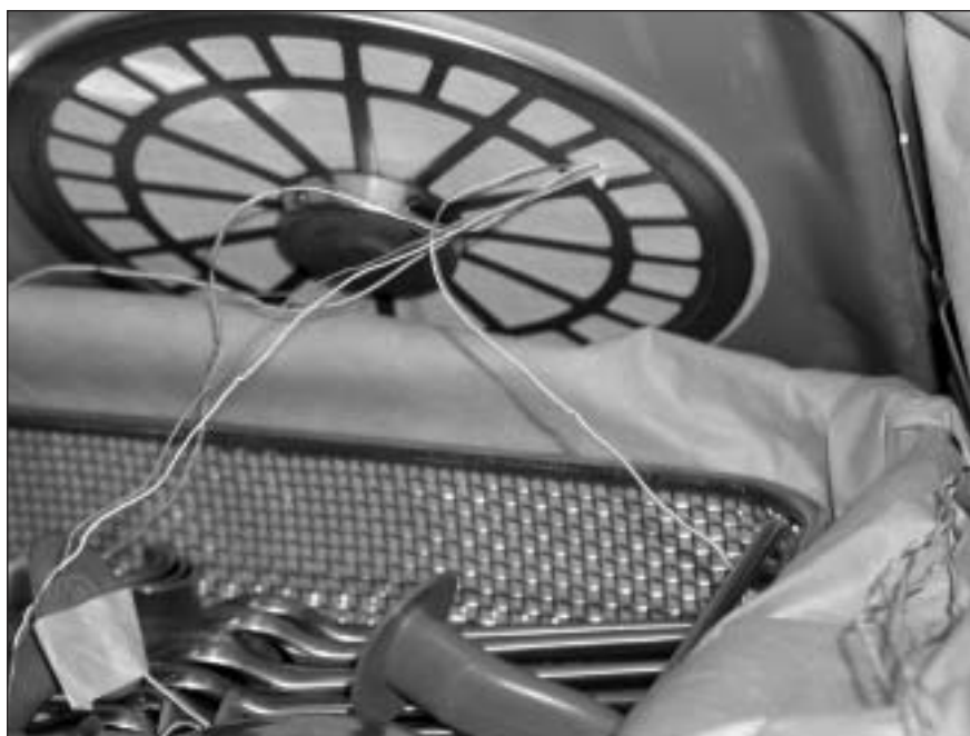
Graphique 1 : Le positionnement recommandé des capteurs de température
